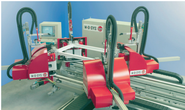
Bild 2. Reibschweißen und Verputzen von PVC-Fensterrahmen in einer Maschine mit einer Gesamtaktzeit von ca. 45 s. Die Investitionskosten sinken um 30 bis 50 % und die Betriebskosten um 10 bis 20 %
