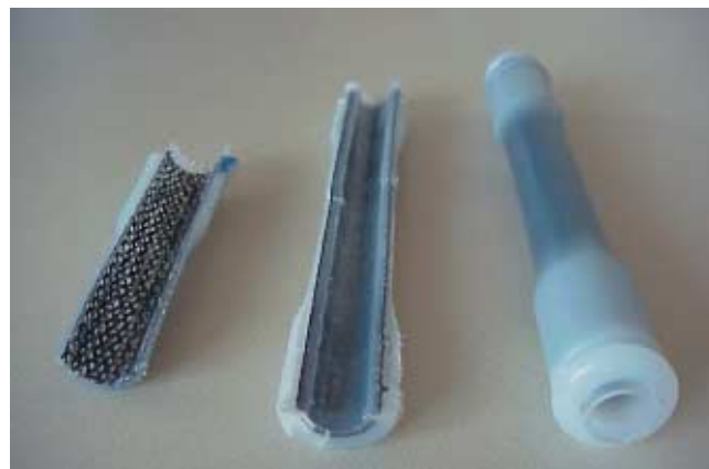
Bild 5. Prüfkörper des Hybrid-Verfahrens für verstärkte Schichtstrukturen
