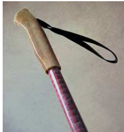
Bild 3. Der Griff wird auf den oberen zylindrischen Schaftteil gesteckt
