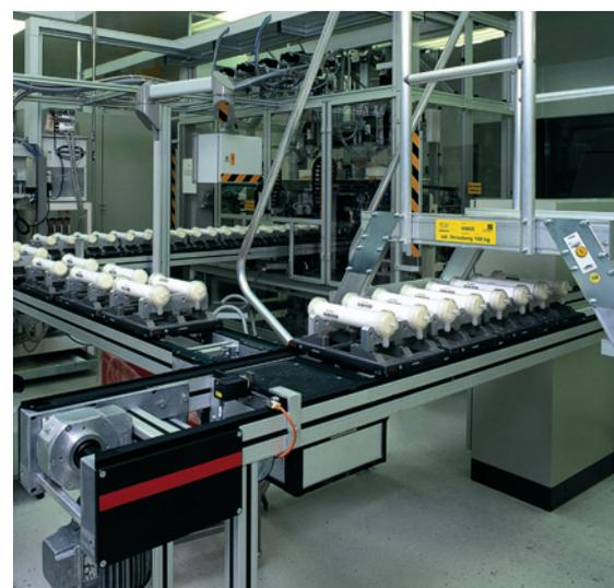
**Bild 4. Endprüfung der fertigen Dialysefilter**
