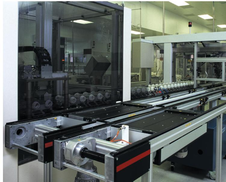
**Bild 1. Stationen der Dialysefilterfertigung: Im Vordergrund werden die Gießdeckel zum Verschließen der zylinderförmigen Gehäuse aufgedrückt. Im Hintergrund der Membranbündelzug** (Fotos: Bosch Rexroth)
