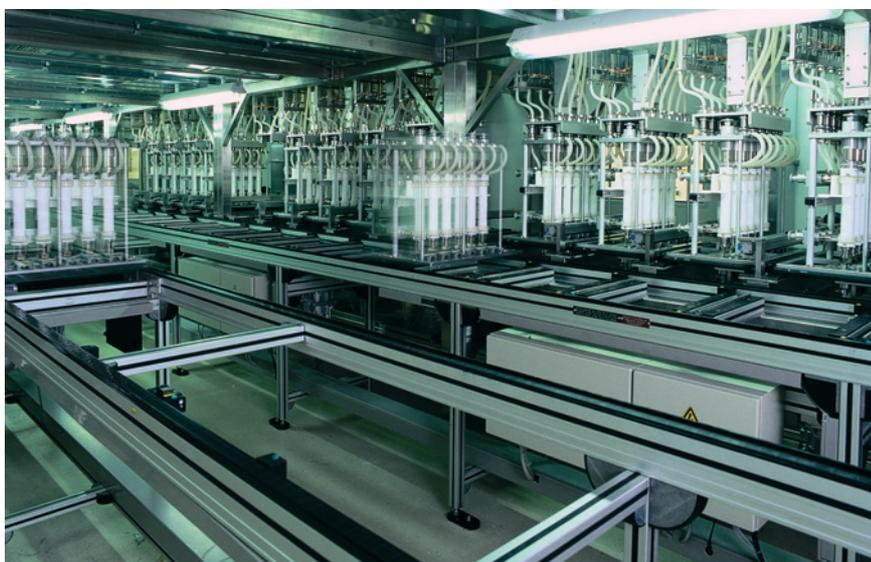
**Bild 3. Die Klimakammer, in der der Spül- und Trocknungsvorgang im Rahmen der Endbehandlung der Dialysefilter stattfindet**
