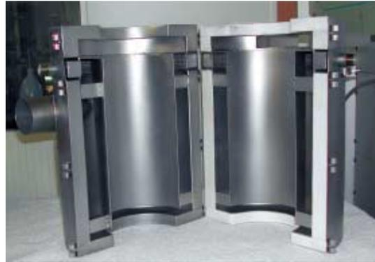
**Bild 4. Erdgasbeheizung für Extruder und Spritzgießmaschinen**
