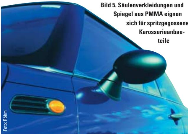
**Bild 5. Säulenverkleidungen und Spiegel aus PMMA eignen sich für spritzgegossene Karosserieanbauteile**
