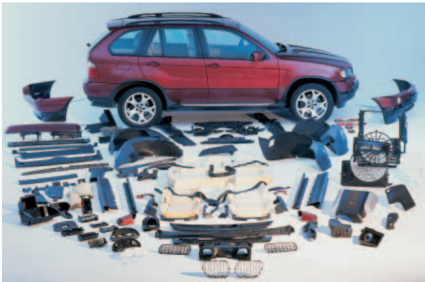
Bild 3. Beispiel BMW X5: Ein großer Teil der Kunststoffe lässt sich bereits wirtschaftlich demontieren und verwerten
