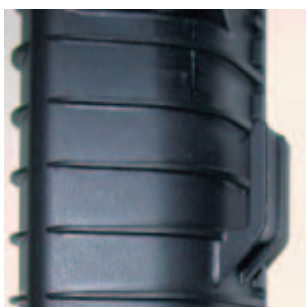
Bild 3. Dünnwandiges Bauteil aus PA66-GF30, geschäumt mit Hydrocerol ITP 820
