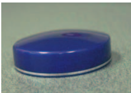
Bild 2. Dünnwandiges Bauteil aus Polyethylen und Polypropylen, geschäumt mit Hydrocerol ITP 810
