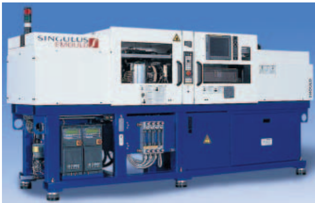
Bild 7. Spritzgießmaschine bei Emould zur Herstellung optischer Datenträger (Quelle: Emould)
