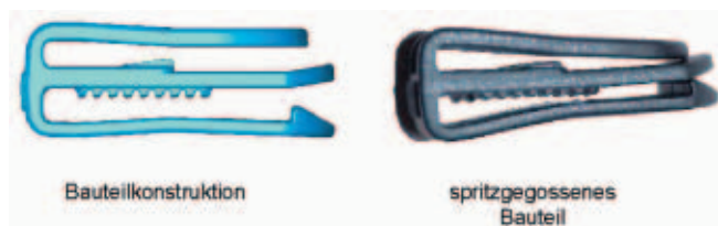
Bild 14. Vergleich der Bauteilkonstruktion mit dem spritzgegossenen Bauteil (Quelle: M-Tec)
