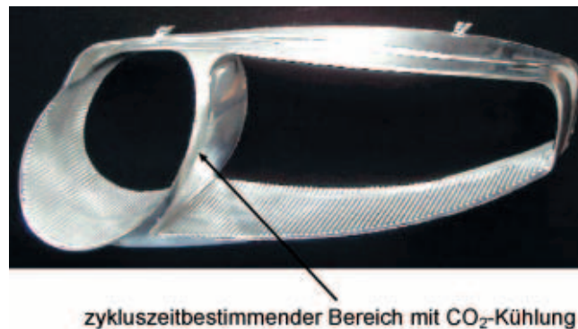
Bild 10. Teilbereichs-temperierung mit CO 2 (Quelle: ISK)
