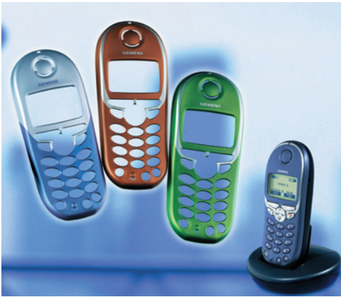
Bild 4. Das (PC+ABS)-Gehäuse dieses schnurlosen Telefons wird in Dünnwandtechnik – kombiniert mit In-Mould-Decoration – in extrem kurzen Zykluszeiten gefertigt
