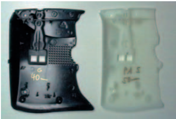
Bild 9. Vergleich zweier Teilfüllungen (links ABS; rechts PA 6)
