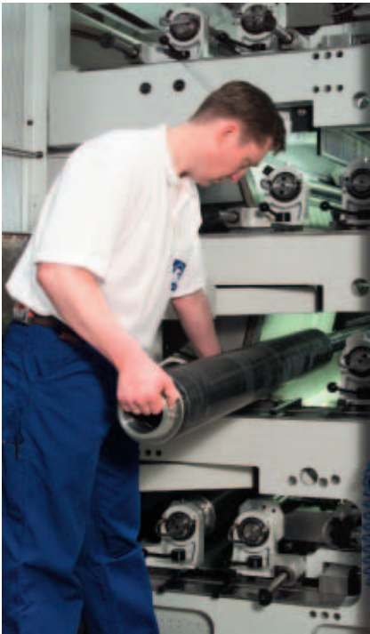
Bild 5. Sleeve-Trägerzylinderwechsel an der Flexpress 16 S (Foto: Fischer & Krecke)
