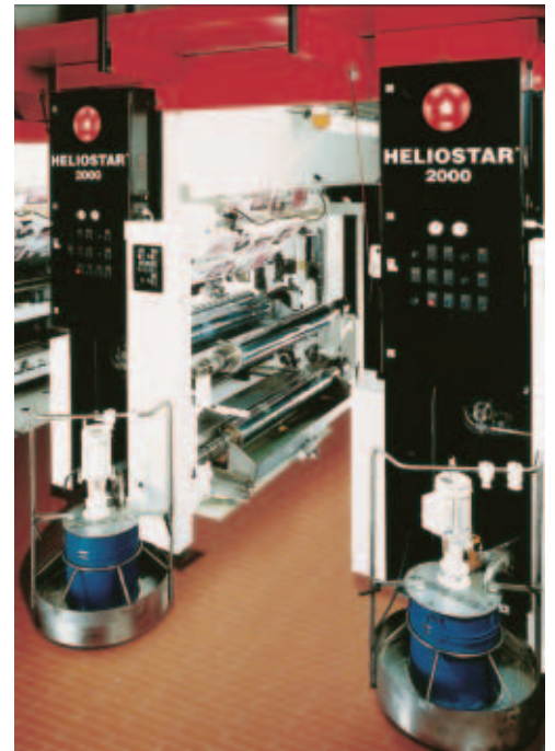
Bild 4. Tiefdruckrotation mit Direktantrieb und Schnellwechseltechnik Ecoplus (Foto: Windmüller & Hölscher)
