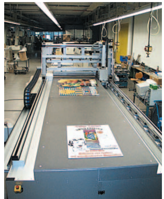
Bild 20. Digitale Druckmaschine DSP mit Anwendungsbeispiel (Foto: Tampoprint)
