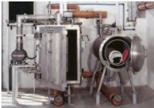
Bild 1. Vakuum-Reaktor zur Offline-Gasphasenfluorierung (Foto: Fluor Technik System GmbH)
