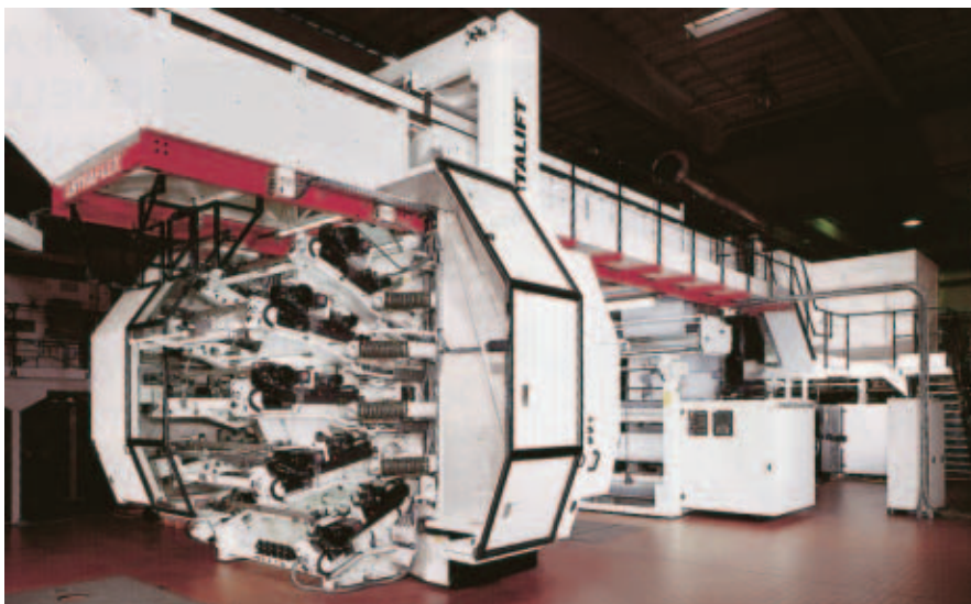
Bild 7. Zentralzylinder-Flexodruckmaschine Astraflex 10 mit zehn vollautomatischen Farbwerken (Foto: Windmüller & Hölscher)
