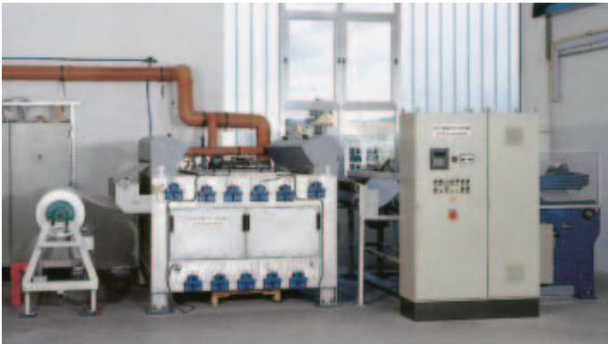
Bild 2. Gasphasenfluorierung im Inline-Verfahren (Foto: Fluor Technik System GmbH)
