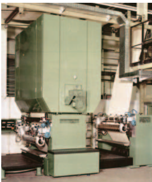
Bild 8. Rundschaablonen-Druckmaschine Magnoroll mit vertikalem Zwischentrockner (Foto: J. Zimmer)
