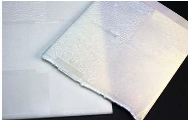
Mustertafel für die unterschiedliche Wirkung eines neu entwickelten Additiv-Masterbatches bei angepassten Maschinparametern
