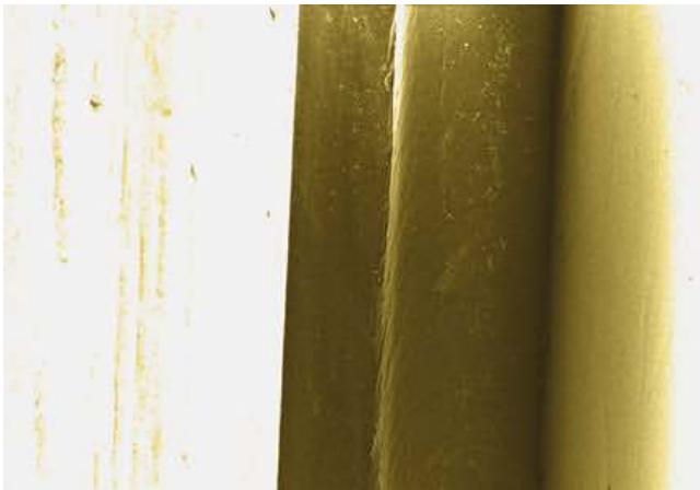
Bild 1. Eine perfekte Schweißnaht, erzeugt durch das TwinWeld3D-Verfahren (150-fache Vergrößerung)
