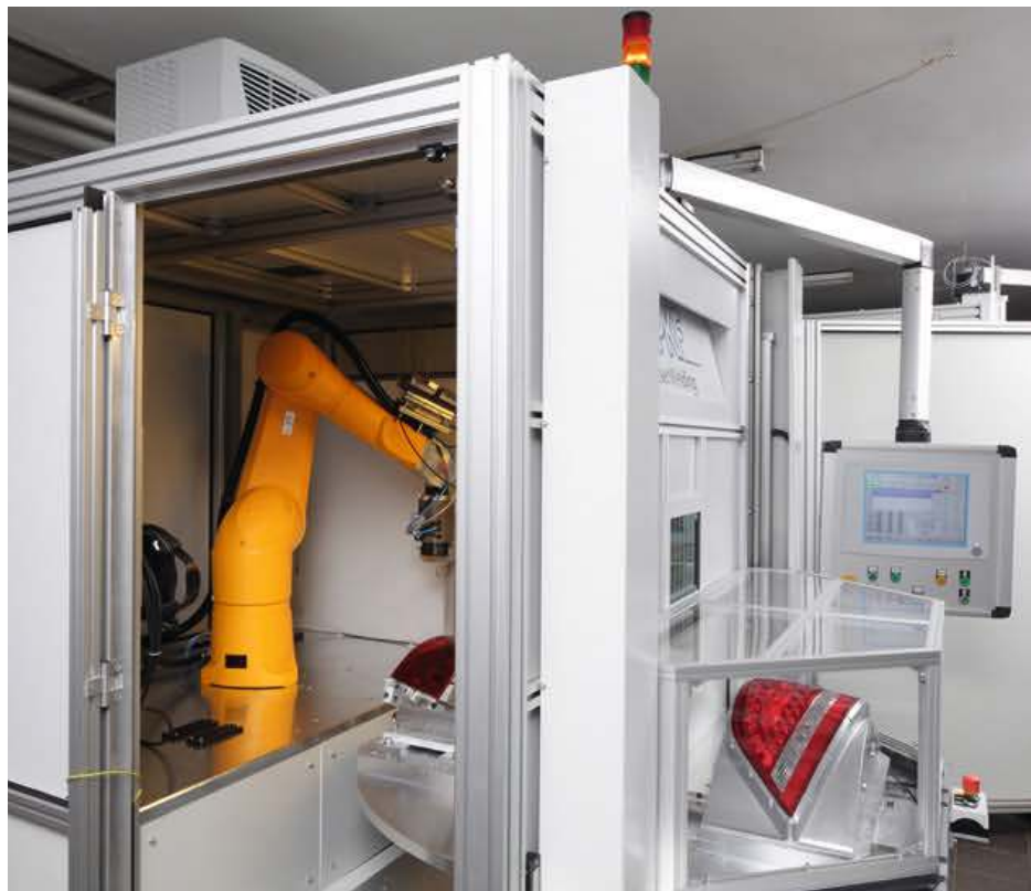
Bild 3. Das TwinWeld3D-Laserschweißsystem kann mit einem Rundschalttisch ausgestattet werden, der eine paarweise Produktion (jeweils linke und rechte Rückleuchte) erlaubt
