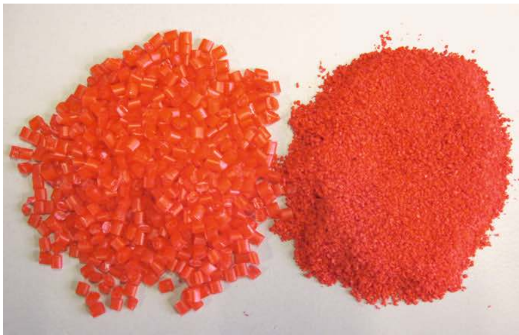
Bild 3. Rot eingefärbtes PP-Granulat (Typ: Sabic PP 505 P und Pigment Red 254, der Farbenwerke Wunsiedel GmbH) vor dem Mahlen (links), und nach dem Mahlen in Pulverform (rechts)
