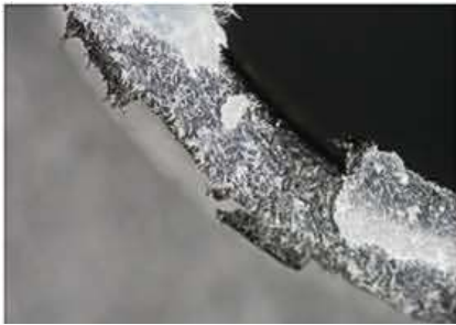
Bild 1. Die Materialanhaftungen zeigen, dass es sich hier um den gewünschten kohäsiven Bruch handelt
