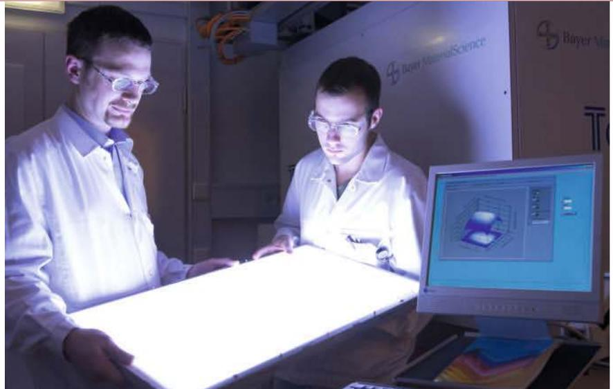
**Bild 5. Diffusorplatten aus Polycarbonat finden auch in Backlight Units von LEDs Verwendung**
