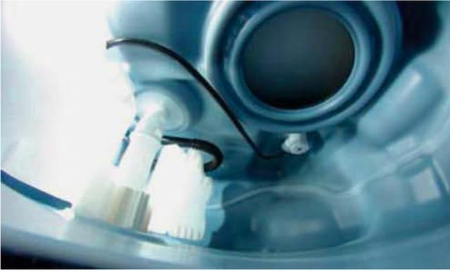
**Bild 5: NGFS-Tank mit integrierten Funktionskomponenten**
