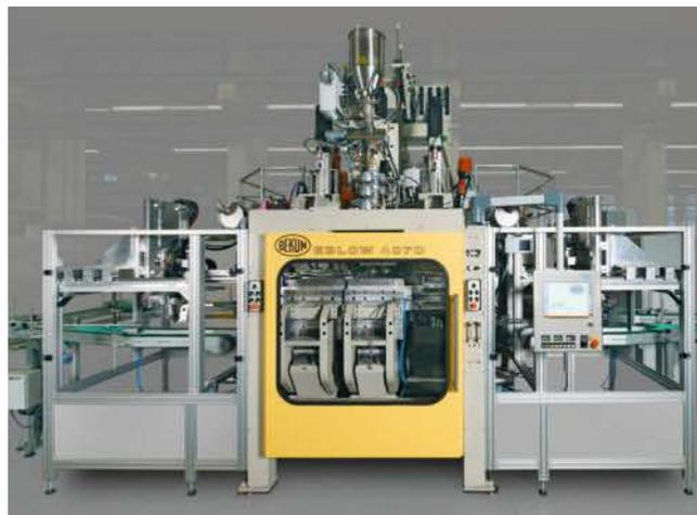
**Bild 1.** Die EBLOW 407 D mit vollelektrischem Antrieb ist eine Zweistationen-Blasanlage für Hohlkörper mit einem Volumen bis zu 10 l (Foto: Bekum Maschinenfabriken)
