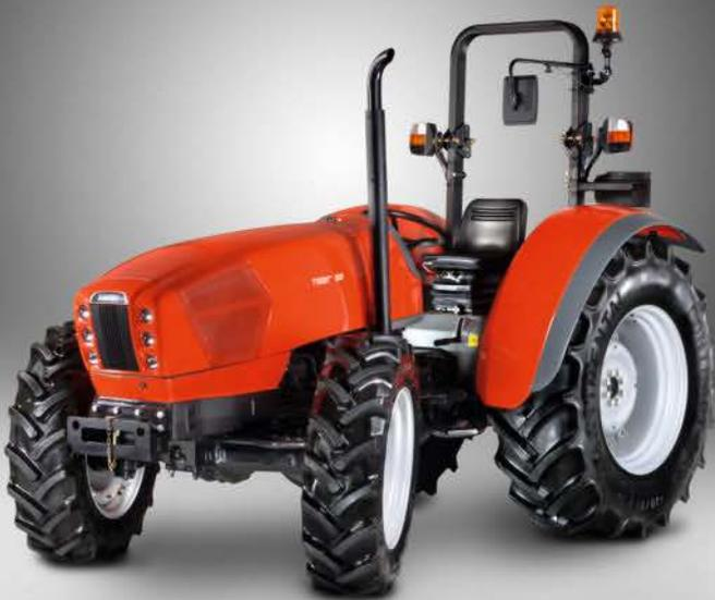
**Bild 2. Motorhaube eines Nutzfahrzeugs, die im LFI-Verfahren und durch In-Mold Painting hergestellt wird** (Foto: KraussMaffei)
