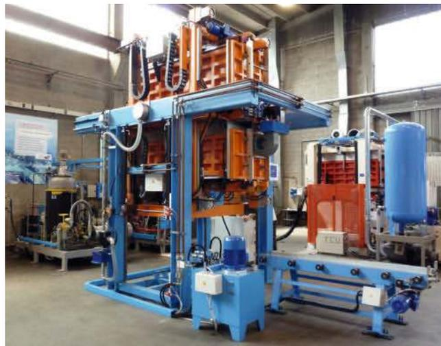
**Bild 1. Cannon-V.A.I.-Anlage zur effizienten Verschäumung von Kühlschränken** (Foto: Cannon)
