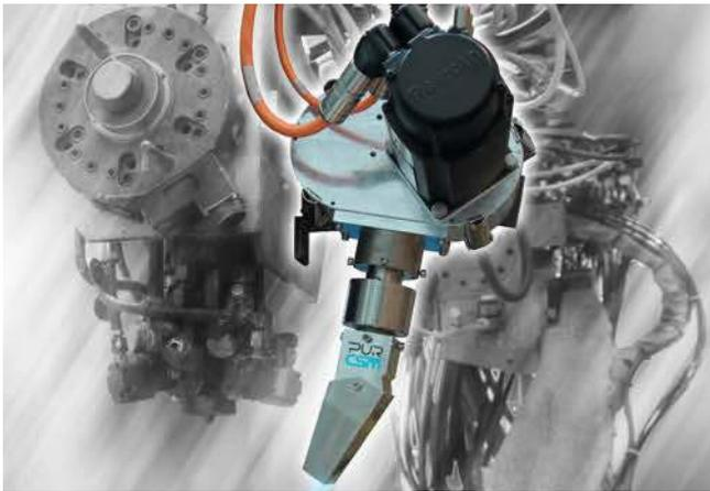
**Bild 3. Nahezu verschleißfreies Schneidwerk für das CSM-Fasersprühen**
