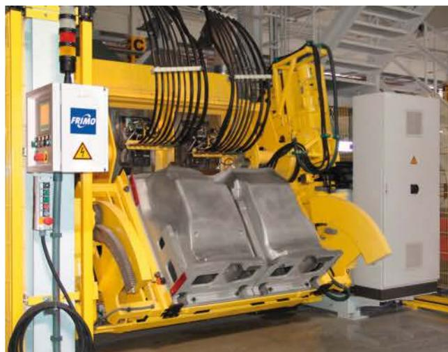
**Bild 4. Elektrisch angetriebene Formenträger mit Pneumatikdruckkissen**
