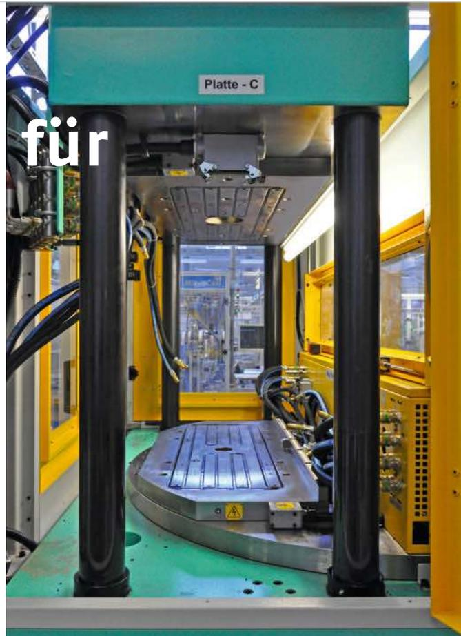
Magnetspannsystem aus drei Magnetspannplatten in vertikaler Spritzgießmaschine an einer Arburg-Rundtischmaschine
