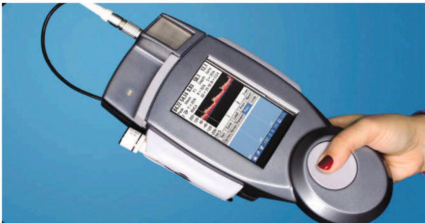
Bild 2. Als wirtschaftliche Alternative zu einem mit Metall beschichteten Gehäuse des tragbaren Geräts zur Erkennung von unsichtbarem Schädel-Hirntrauma vor Ort des Herstellers Multigon Industries bieten Kunststoff-Compounds mit Edelstahlfasern eine vergleichbare Abschirmung
