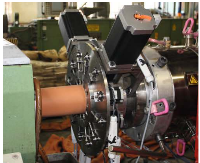
Bild 5. Flexringwerkzeug in Kipptechnologie, mit dem erstmals sowohl exzentrische als auch unsymmetrische Dickenunterschiede ausgeregelt werden können
