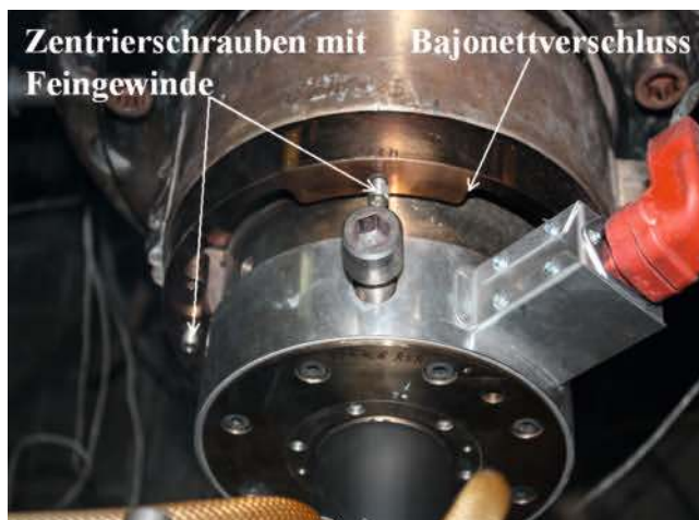
Bild 2. Kippdüse mit Bajonettverschluss, mit einer engen Zentrierpassung zwischen der Düse und dem Kopf sowie mit Feingewindeschrauben (M6 x 0,5) zur feinfühligeren Optimierung der relativen Position zwischen der Düse und dem Dorn
