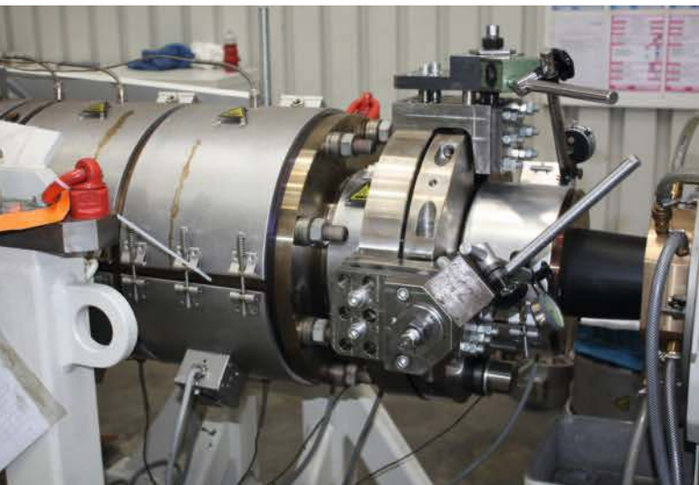
Bild 4. Mit einer Kippdüse nachgerüsteter Rohrkopf, bei dem zum Kippen der Düse nur noch zwei in 90° angeordnete Stellvorrichtungen vorhanden sind, die zwar über größere Stellschrauben betätigt werden, deren Stellweg aber aufgrund einer nachgeschalteten mechanischen Untersetzung extrem feinfühlig ist
