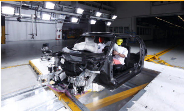
Bild 2. Erprobungsträger mit CFK-Fahrgastzelle (Foto: BMW)
