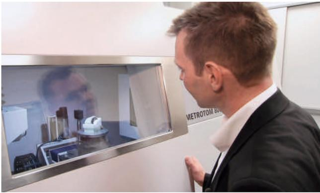
Ein computertomografisches Messgerät unterstützt die Entwicklung technischer Formteile aus Silicon. Die Erkenntnisse der Messung fließen direkt in die Bauteilentwicklung ein und helfen, unnötige Werkzeugkorrekturschleifen zu vermeiden
