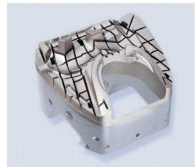
**Werkzeug des verrippten Staubsaugeroberteils mit konturnaher Kühlung**
