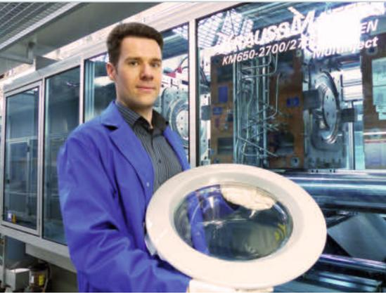
**Bild 1. Ein Mitarbeiter aus der Produktion mit dem Waschmaschinentürmodul: Das Werkzeug mit konturnaher Kühlung läuft auf einer Wendeplattenmaschine**
