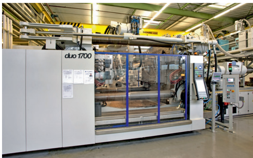
Bild 1. Die größte Maschine von Dr. Schneider, auf der täglich 1200 Fensterrahmen gefertigt werden, wurde 2010 in Betrieb genommen. Simatic WinCC mit der Option powerrate visualisiert die Energiedaten aller 100 Maschinen des Werks
