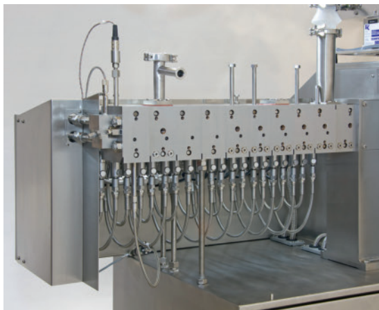
Das Verfahrensteil des Extruders ist pharmage-recht ausgeführt. Dazu gehören eine Verklei-dung aus Edelstahl und leckagefreie Kühlwas-serkupplungen
