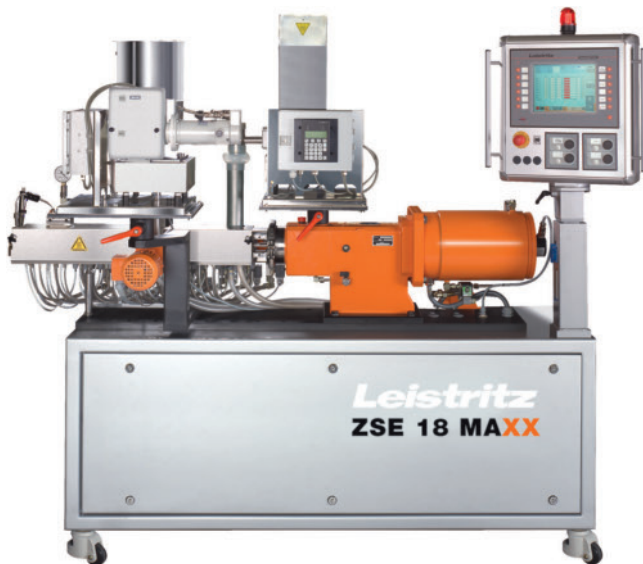
Bild 3. Durch eine angepasste Schaftverzahnung besitzt der Doppelschneckenextruder des Typs ZSE 18 Maxx ein größeres freies Volumen als seine Vorgänger (Foto: Leistritz Extrusionstechnik)
