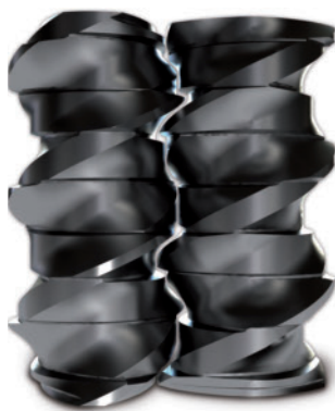
Bild 5. Die Schneckenelemente der T-Profil-Technologie ermöglichen größere Scher- und Dehnströmungen und verbessern dadurch die dispersive und distributiven Durchmischung (Foto: Extricom)
