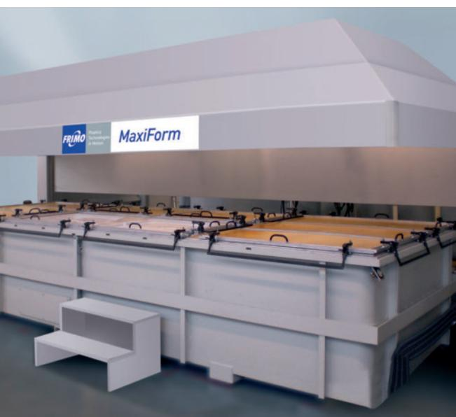
**Bild 3. MaxiForm – XXL Platten-Thermoformen** (Foto: Frimo)
