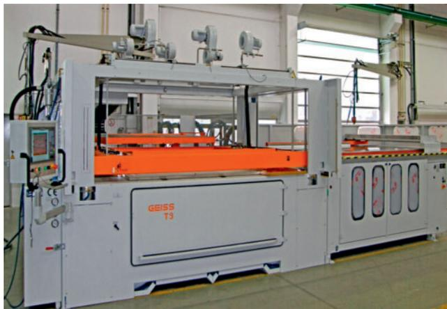
**Bild 4. Thermoformmaschine zur Herstellung von großen Sanitärprodukten**
