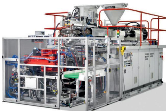
**Bild 3.** Die vollelektrische Blasformmaschine **UMA 12 SeCo2 EnergiaZero** produziert Teile im sequenziellen Coextrusionsverfahren und ist dafür mit verschiedenen elektrischen Antriebstechniken ausgestattet
