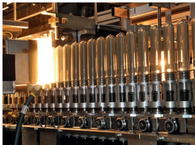
**Bild 6. Die Heizstreckenkonfiguration der Maschinenreihe SBO Universal2 Eco zeichnet sich durch einen reduzierten Energieverbrauch aus**
