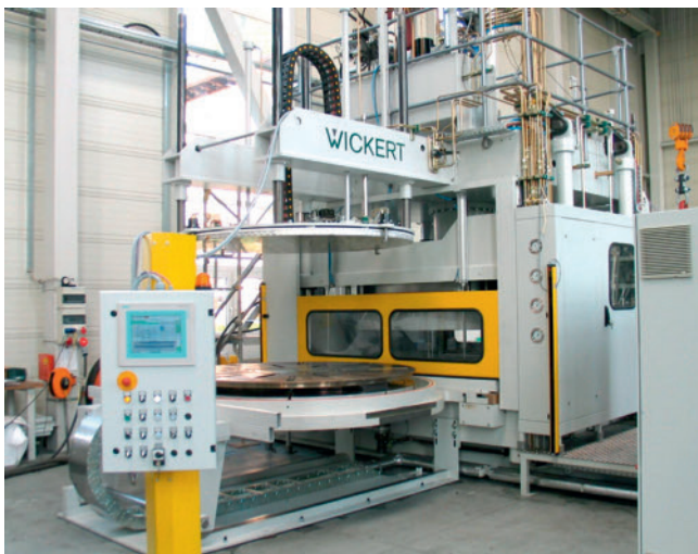
Bild 1. Oberkolbenpresse WPK 5000 S mit Heizlattensystem Isotemp (Foto: Wickert Maschinenbau)
