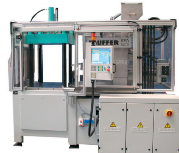
Bild 4. Kunststoffpressautomat KPA mit modularem Aufbau
