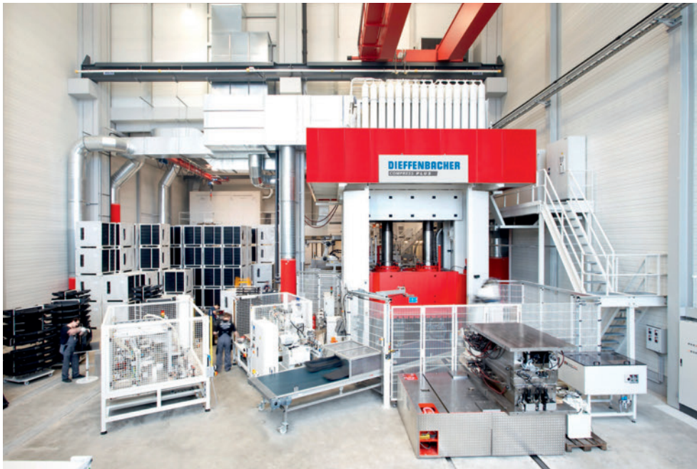
Bild 5. Anlage zur Direktverarbeitung von langfaserverstärkten Thermoplasten nach dem LFT-D-Verfahren
