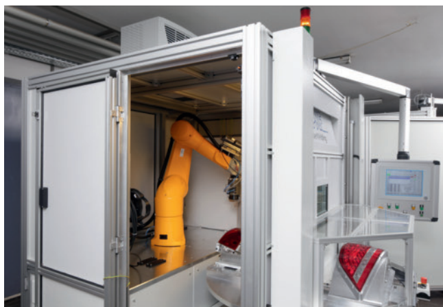
Bild 7. Robotergestütztes Schweißen großer Freiformbauteile im Wärme-feld, hier mit Rundschtaltisch für eine schnelle Beschickung (Foto: LPKF)
