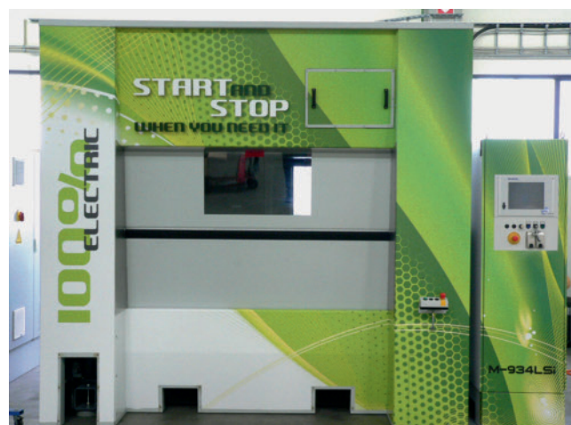
Bild 2. Vollelektrische Vibrationsschweißmaschine (Foto: Branson)
