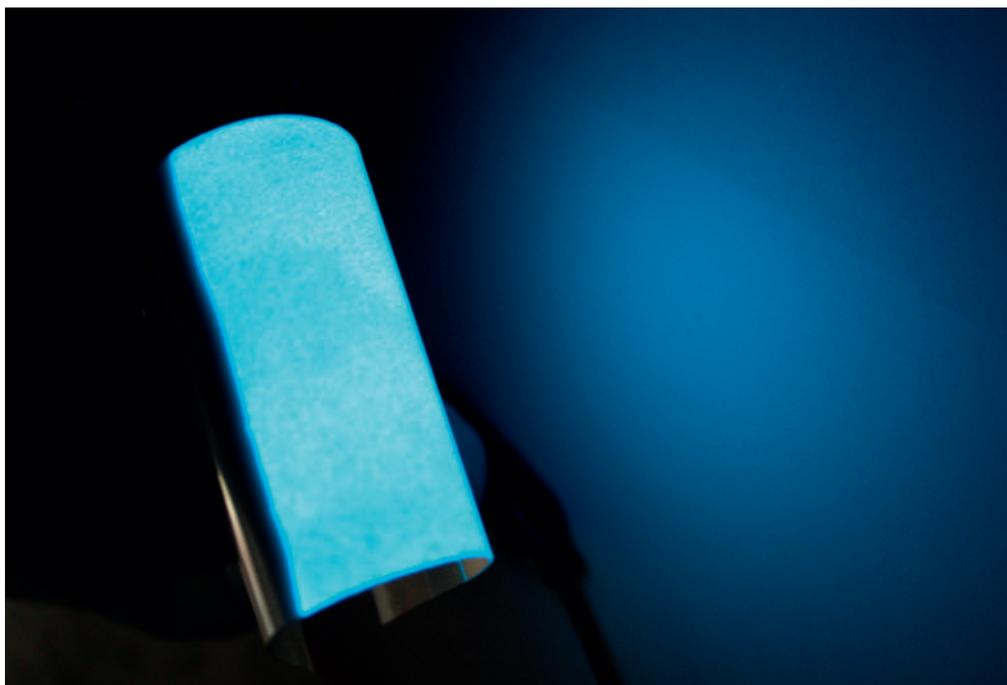
Bild 3. Elektrolumineszenzfolie mit transparenten, flexiblen Elektroden aus CNTs
