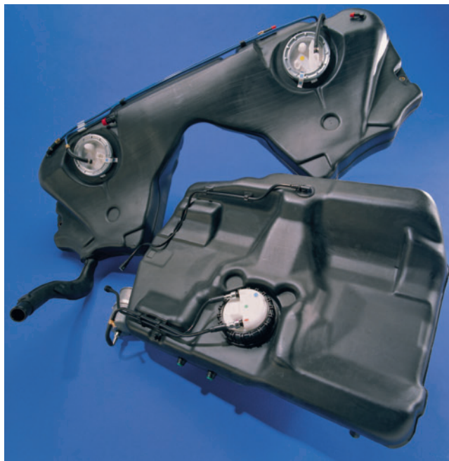
Bild 7. Das PE-HD Lupolen 4261 AG BD ist nicht nur beständiger gegen Biodiesel als viele Standard-Polyethylene; es lässt sich durch eine Off-line-Fluorierung auch hervorragend gegen peroxidhaltige Kraftstoffe, sog. dirty fuels, stabilisieren
