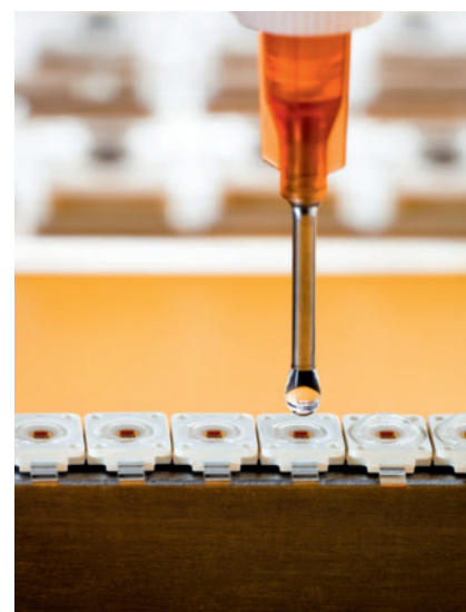
Bild 1. Das neuartige Siliconelastomer Lumisil wird in flüssiger Form direkt auf den LED-Chip aufgetragen
