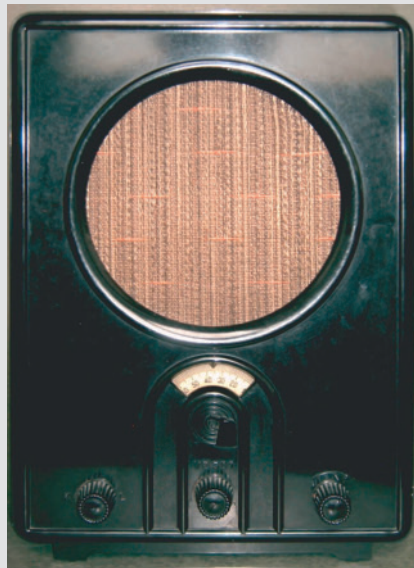
Bild 4. Volksempfänger, das Gehäuse bestand aus einer holzmehlgefüllten Phenolharz-Schnellpressmasse (Foto: FCME)
