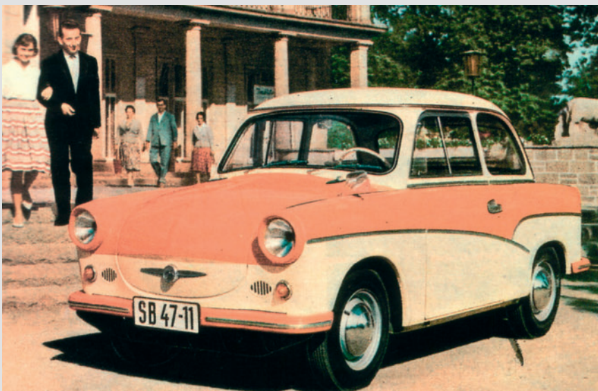
Bild 7. Die Trabant-Karosserie bestand aus Phenolharzteilen mit Baumwolle als Trägermaterial, die das Stahlgerippe umgaben (Foto: [10])
