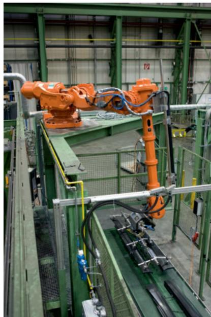
**Machine Sync optimiert Roboter und Peripherie – bei der Entnahme, dem Ablegen der Spritzgussteile auf dem Förderband und beim Rückfahren des Roboters in die Ruheposition**
