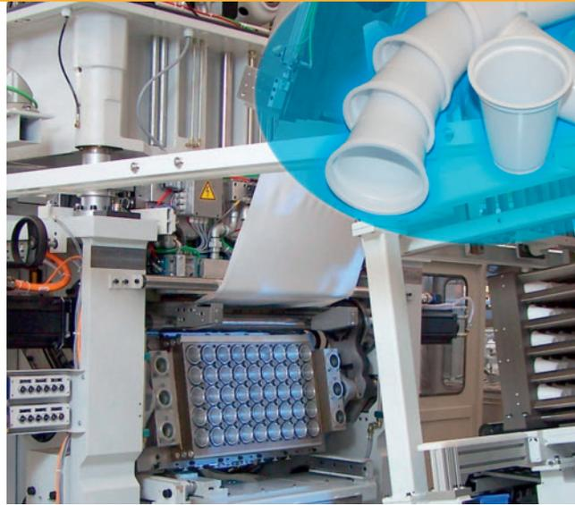
**Bild 2. Thermoformmaschinen der dritten Generation mit nochmals gesteigerter Taktzahl** (Foto: Illig)
