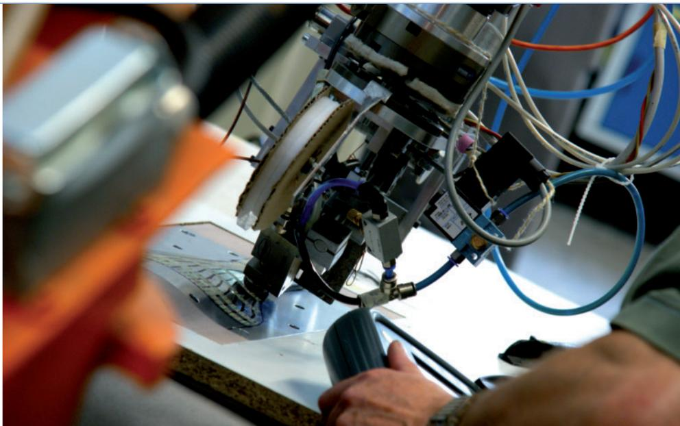
Im neu entwickelten Verfahren werden die gebündelten Endlosfasern mithilfe eines Roboters abgelegt und klebfixiert (Fotos: KVB)
