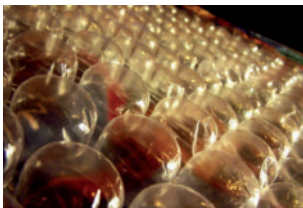
Bild 4. Eine PA6-Schicht im Inneren sichert den Polstereffekt von Luftpolsterfolien über einen längeren Zeitraum (Foto: Torninova)
