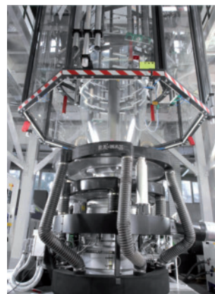
Bild 2. Das CR-Twin-System besteht aus zwei carbonfaserverstärkten Kühlringen, mit denen die Luftströmung im Bereich der Folienblase optimiert wird (Foto: Macchi)
