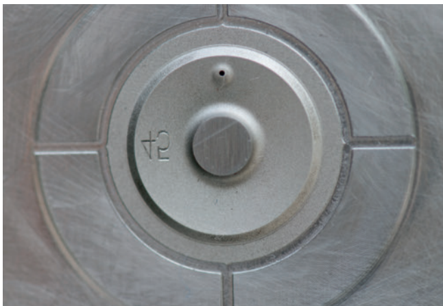
Bild 4. Formeinsatz mit Anschnittbohrung, deren Durchmesser mit 0,35 mm sehr klein gewählt wurde
