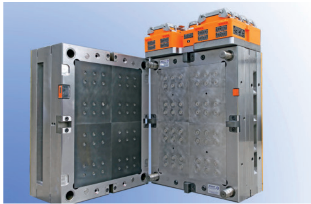
Bild 3. Die Werkzeugplatten: Jeweils zwölf Formnester wurden auf vier Einsätze verteilt und mit zehn Temperierkreisläufen versehen
