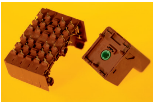
Steuermodule wie diese von der Firma Diehl-Ako bestehen aus halogenfrei flammgeschütztem Ultramid, dem Polyamid der BASF. Die Bauteile müssen die Anforderungen der Norm IEC 60335-1 für unbeaufsichtigt betriebene Hausgeräte erfüllen (Foto: BASF)
