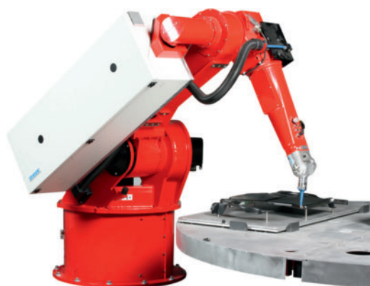
Bild 4. Laserroboter RV6L-CO 2 mit 1000 Watt-CO 2 -Laser zur Materialbearbeitung
