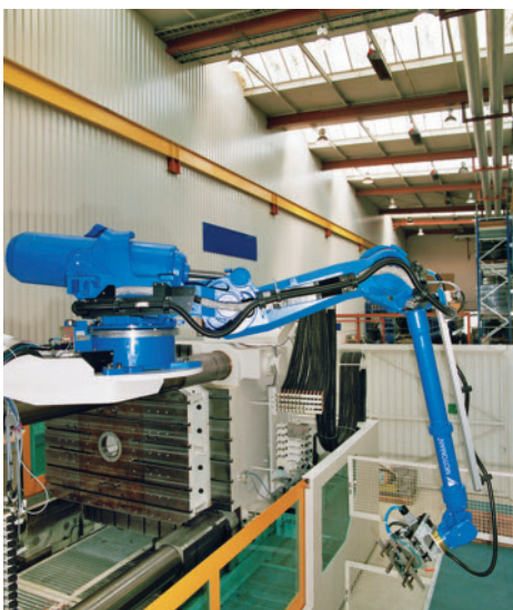
Bild 1. Be- und Entladung einer Spritzgießmaschine mit dem Konsolroboter ES200RN-120
