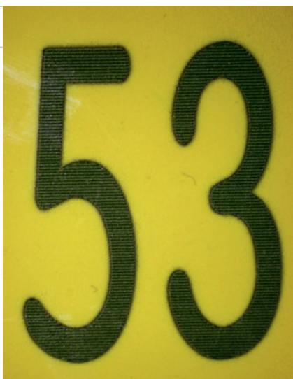
Bild 4. Beispiel für Beschriftung mittels Karbonisierung
