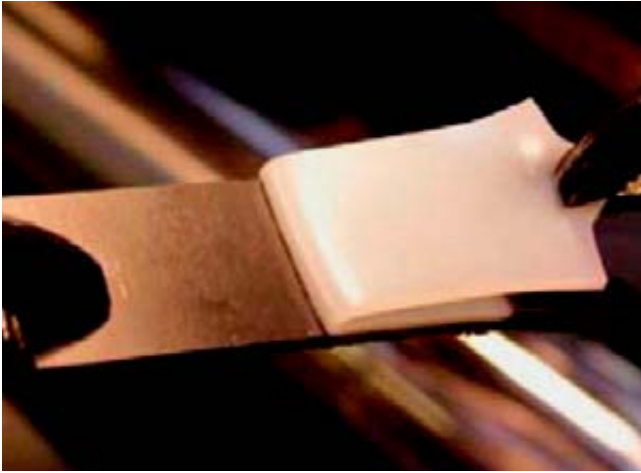
Bild 9. Hervorragende Verbundhaftung zwischen Elastollan TPU-X und Ultramid CR (PA 66-GF) ohne zusätzlichen Haftvermittler (Foto: Elastogran)
