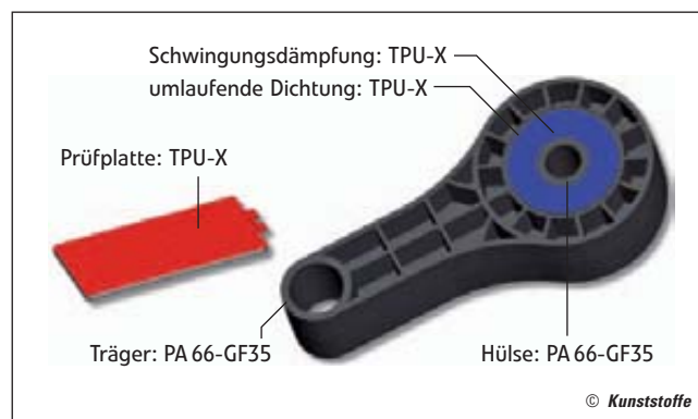
Bild 3. Das Bauteil wird durch eine Kombination aus reaktivem Compoundieren und Mehrkomponenten-Spritzgießen hergestellt
