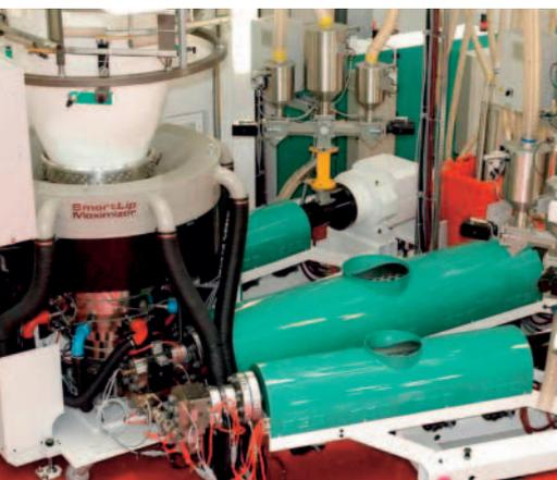
3-Schicht-Blasfolienanlage mit neuem „Smart Lip Maximizer“-Kühlring
