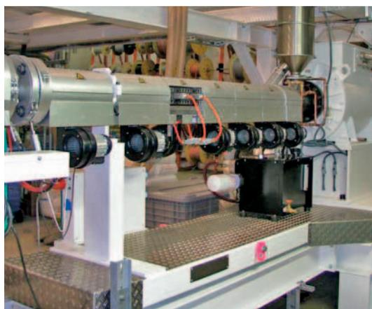
Schnellläufer mit 72 mm-Schnecke und Direktantrieb
