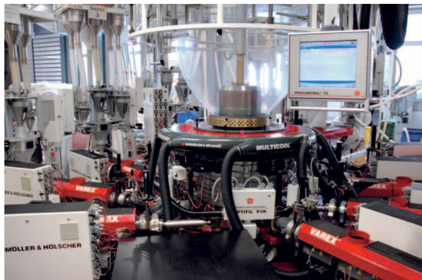
Die Beherrschung extremer Schichtverhältnisse, perfekte Einzelschichtverteilung, geringste Verweilzeiten und sehr hohe Ausstoßleistungen kennzeichnen den neuen 9-Schicht Blaskopf
