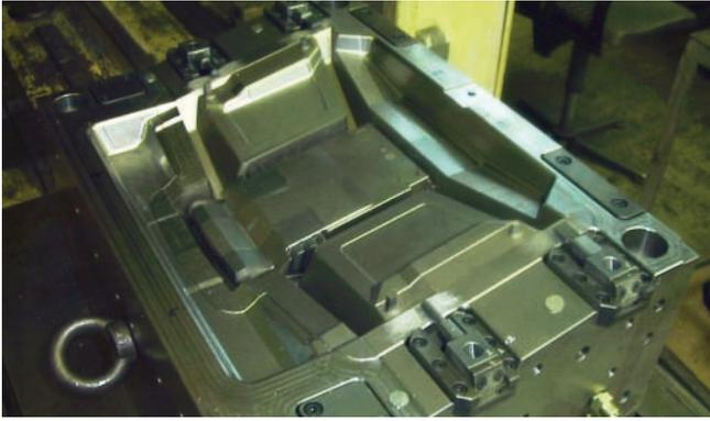
Das Werkzeug zur Ausformung des Sitzträgerteils bei der Endprüfung auf der Tuschierpresse (Foto: Deckerform)
