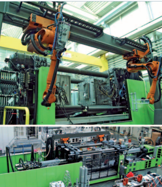
Die 2K-Großmaschine Engel Duo Combi M mit den beiden gegenüberliegenden Spritzaggregaten und dem zentralen, um seine vertikale Achse drehbaren Werkzeug-Mittelblock wurde bei der ersten Vorführung von zwei auf einer schnellen Linearachse verfahrenen Industrierobotern bedient
