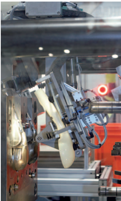
Die Fertigungszelle zur Produktion des Griffs einer Handbrause in einem 2fach-Werkzeug beinhaltet ein System zur Qualitätskontrolle
