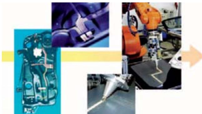
**Bild 1. Von der Verdrahtungsstudie zur prototypischen Realisierung der Montage von FFCs**
