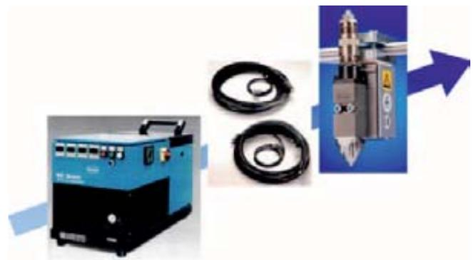
**Bild 3. Anlagentechnik zum Klebstoffauftrag: Klebstoff-Schmelzgerät MX 4003 mit Zahnradpumpe (links), Verbindungsschläuche mit elektronischen Temperatursensoren (Mitte), Klebstoff-Auftragsköpfe (rechts) (Quelle: Nordson)**
